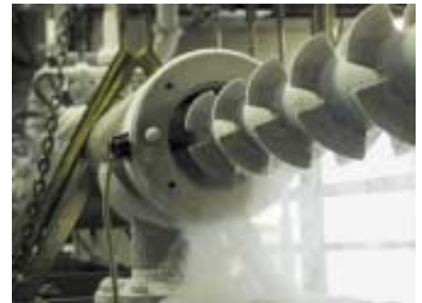
2: Ansicht der geöffneten Kühlschnecke in der Kaltmahlanlage
